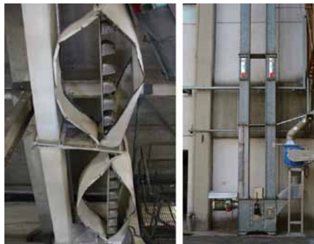
3. ÁBRA: FELROBBANT ÉS VÉDELEMMEL ELLÁTOTT ELEVÁTOR
