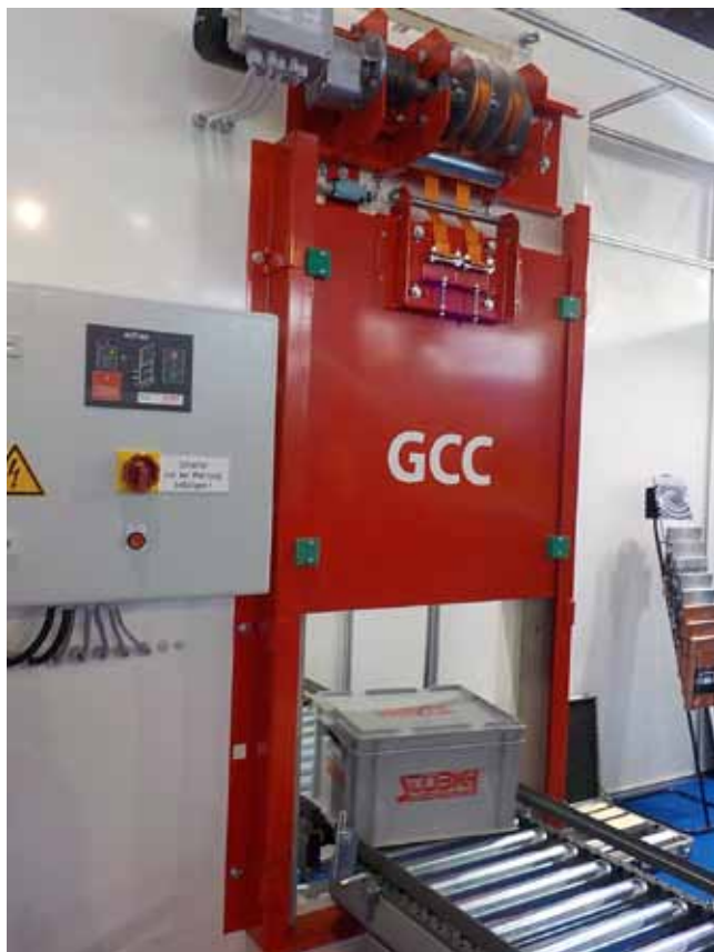
SZÁLLÍTÓSZALAG TŰZGÁTLÓ LEZÁRÁSA
