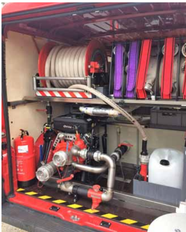
2 KÉP: A GYORSBEAVATKOZÓ TÖMLŐDOB BEÉPÍTÉSE
