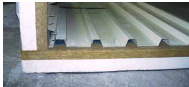
SZERELT TETŐFÖDÉM MSZ EN 13823 SBI PRÓBATEST
