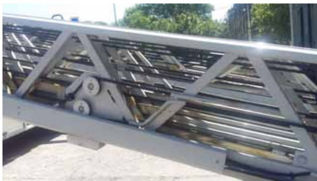
FAVÁGÁS UTÁN A VEZÉRLŐKÁBEL, A KÖTÉLZET FESZÍTÉSE ÉS A CSÚSZÓ ELEMEK GONDOS TISZTÍTÁS IGÉNYELNEK
