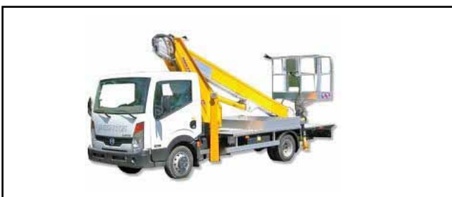
TELESZKÓPGÉMES KOSARAS EMELŐ 3500 KG ÖSSZTÖMEGŰ ALVÁZON
