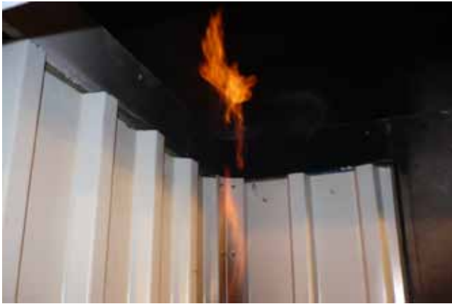
SZERELT TETŐFÖDÉM SBI VIZSGÁLATA (MSZ EN 13823)
