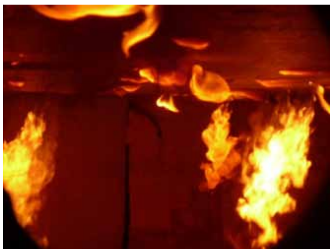
SZERELT FÖDÉMSZERKEZET MSZ EN 1365-2:2015 SZABVÁNY SZERINTI TŰZÁLLÓSÁGI TELJESÍTMÉNY VIZSGÁLATA A KEMENCE TÉR FELŐL
