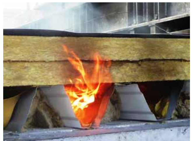
SZERELT FÖDÉMSZERKEZET MSZ EN 1365-2:2015 SZABVÁNY SZERINTI TŰZÁLLÓSÁGI TELJESÍTMÉNY VIZSGÁLATA VÍZSZIGETELŐVEL – A PÁRAZÁRÓ FÓLIA ÉG
