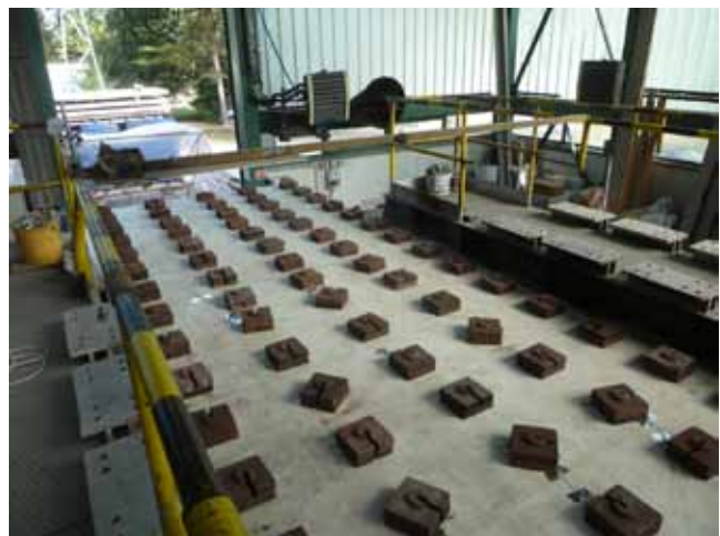
SZERELT TETŐFÖDÉM SZERKEZET MSZ EN 1365-2:2015 szabvány szerinti tűzállósági teljesítmény vizsgálata terheléssel, csapadékvíz szigeteléssel.
