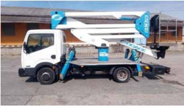
ÖSSZETETT GÉMES MEGOLDÁS: 3500KG ÖSSZTÖMEG, 20 MÉTER MUNKAMAGASSÁG
