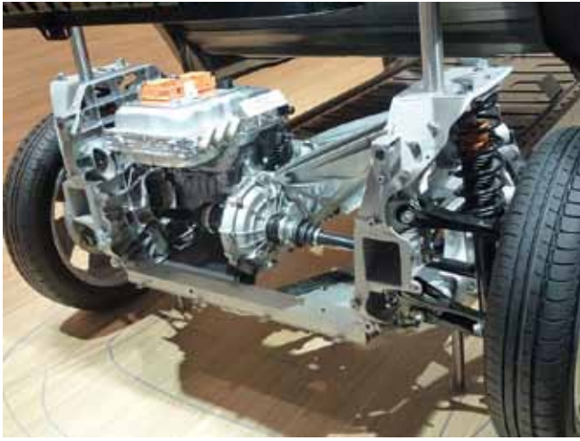
EME – VILLANYMOTORT MEGHAJTÓ ÉS FELÜGYELŐ INVERTER
