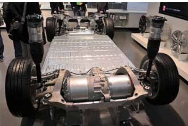
A TESLA MODEL S ALVÁZA, KÖZÉPEN (NORMÁLIS ESETBEN A PADLÓLEMEZ ÁLTAL TAKART) AKKUMULÁTOROKKAL
