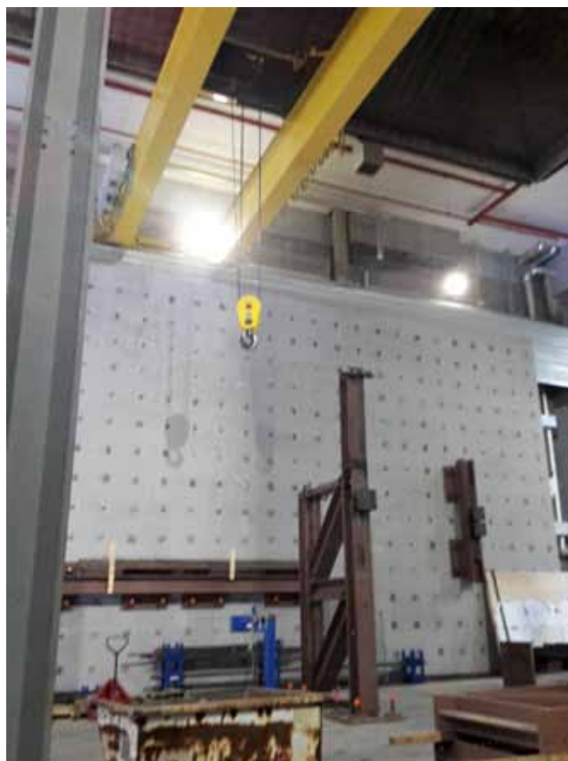
A VALÓS LÉPTÉKŰ SZERKEZET ÉPÍTÉSI TERÜLETE, VASBETON SEGÉD FALLAL ÉS HÍDDARUVAL
