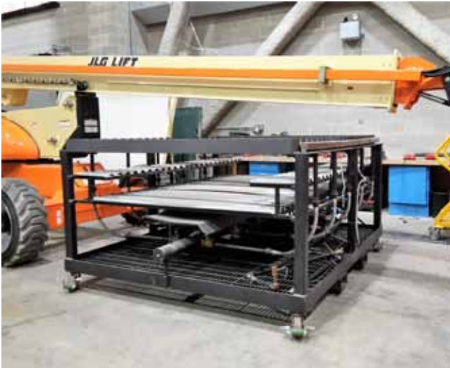
EGYEDI KIALAKÍTÁSÚ GYÚJTÓFORRÁS A VALÓS LÉPTÉKŰ SZERKEZETEKHEZ, A PONTOS SZABÁLYOZHATÓSÁG ÉRDEKÉBEN GÁZZAL ÜZEMELTETVE
