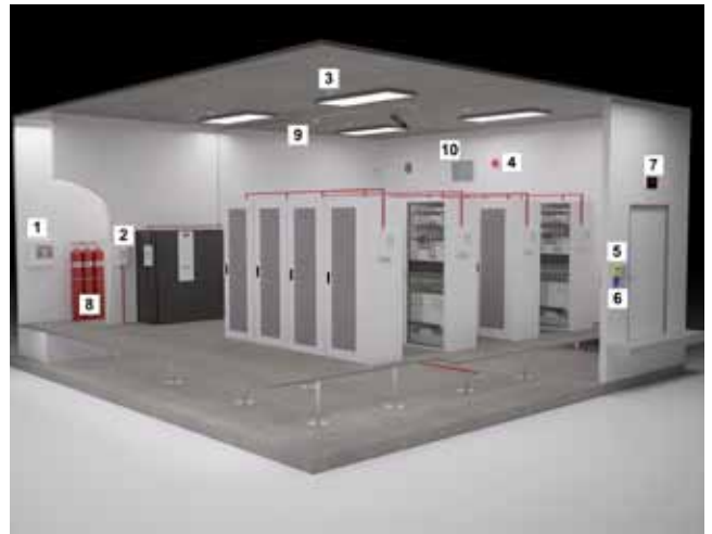
BEÉPÍTETT AUTOMATIKUS OLTÓRENDSZER RÉSZEI
