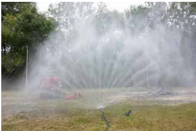
VÍZPAJZS – SUGÁRZÓ HŐ ELLENI VÉDELEM, GÁZOK TERJEDÉSÉNEK KORLÁTOZÁSA
