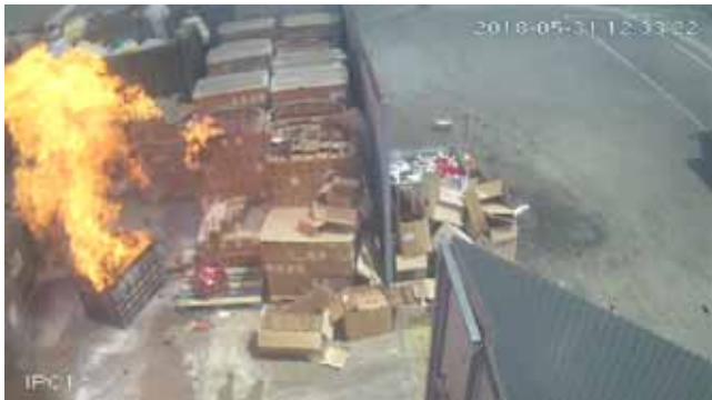
A TŰZ ÁTTERJEDÉSE A MŰANYAG LÁDÁRÓL A RAKLAPOKRA
