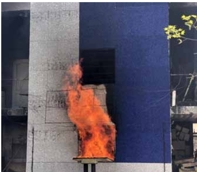
ÉMI HOMLOKZATI TŰZTERJEDÉSI VIZSGÁLAT: TH 45 PERC
