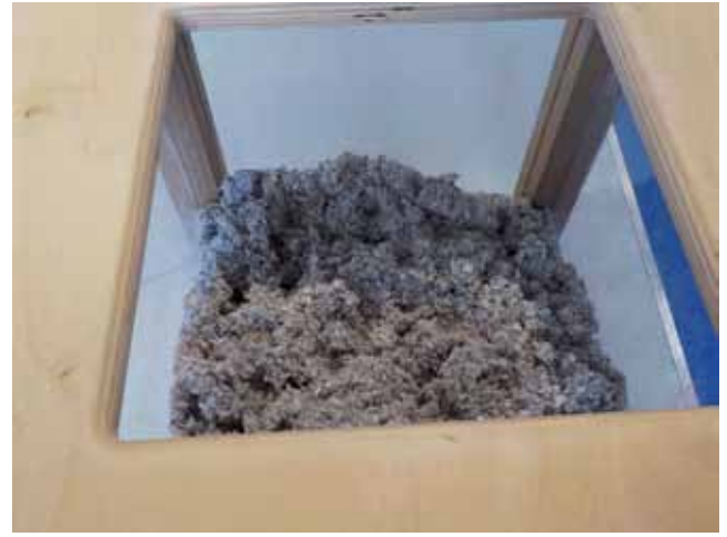
ÖMLESZTETT CELLULÓZ PADLÁS ÉS TETŐTÉR HŐSZIGETELÉSÉRE
