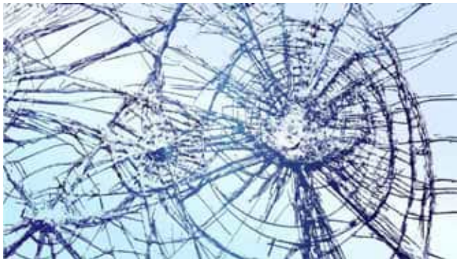
KALAPÁCSÜTÉSNYOMOK BETÖRÉSBIZTOS ÜVEGEN
