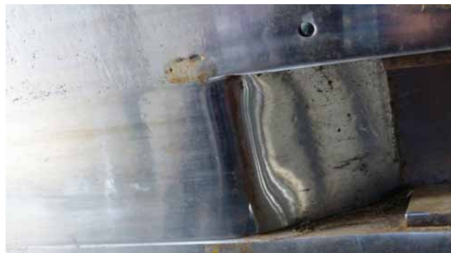
A BÁLÁZOTT ANYAG SÚRLÓDÁSA PRÉSCSATORNÁBAN A KÉPEN LÁTHATÓ KOPÁS ÜZEMSZERŰ ANYAGVESZTESÉG JELEIT MUTATJA
