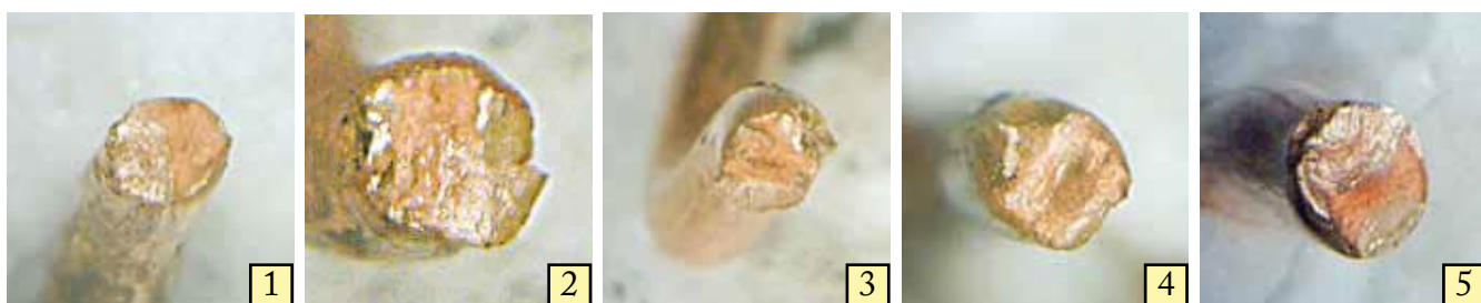
I. ÁBRA TŰZTŐL NEM KÁROSODOTT RÉZVEZETÉKEK TÖRÉSI FELÜLETE (ÁTMÉRŐ 1,5 MM, NAGYÍTÁS 20X)
