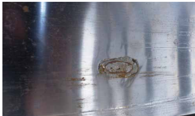
JÓL LÁTHATÓAK EGY KORÁBBI JAVÍTÁS NYOMAI A PRÉSCSATORNA OLDALFALÁBAN
