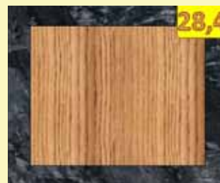
1120 g/m 2 PROMADUR®-ral védett fapillér keresztmetszetének fogyása 60 perc tűzhatás után
