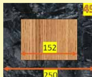
Védetlen fapillér keresztmetszetének fogyása 60 perc tűzhatás után
