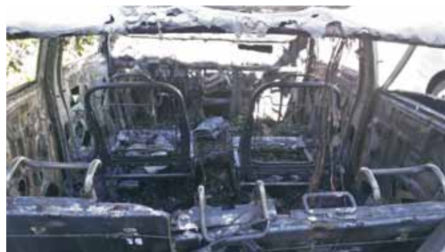
GÉPJÁRMŰ BELSEJE AKKUMULÁTORTŰZ UTÁN
