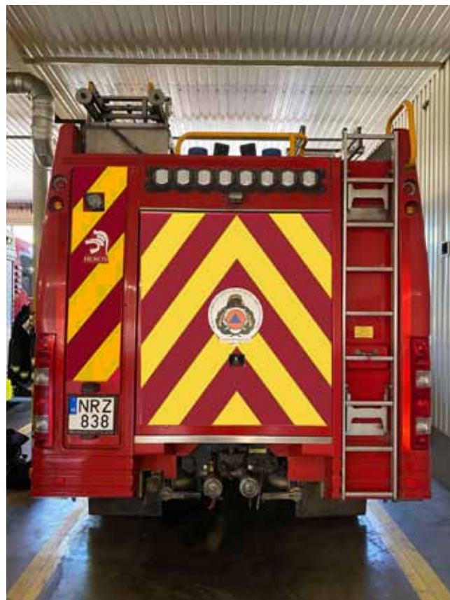
A HAZAI GYÁRTÁSÚ HEROS AQUADUX-X 4000 HÁTULJA „CHEVRON” MINTÁZATTAL
