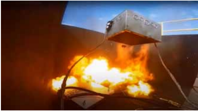
63 AH KAPACITÁSÚ, ÚN. TASAKOS CELLÁKBÓL ÁLLÓ AKKUMULÁTOR: A HŐMEGFUTÁS PILLANATA
