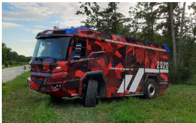
AZ ÁLCAFESTETT RT PROTOTÍPUS, MEGEMELT KAROSSZÉRIÁVAL
