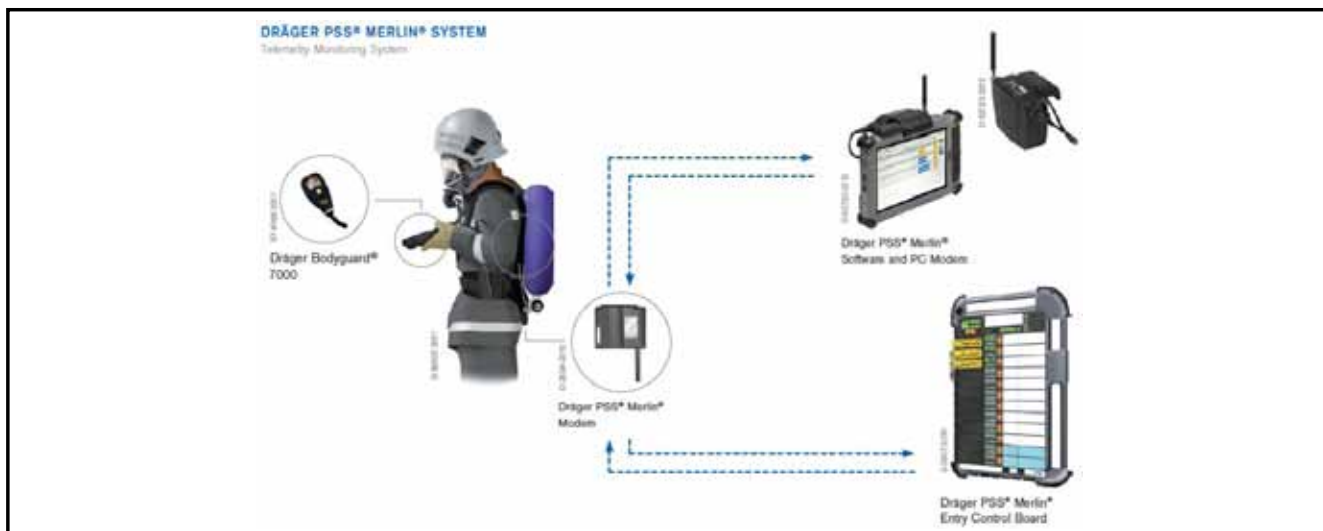
A DRÄGER TELEMETRIAI RENDSZERE A LÉGZŐKÉSZÜLÉKET VISELŐK TÁVOLI MEGFIGYELÉSÉRE
