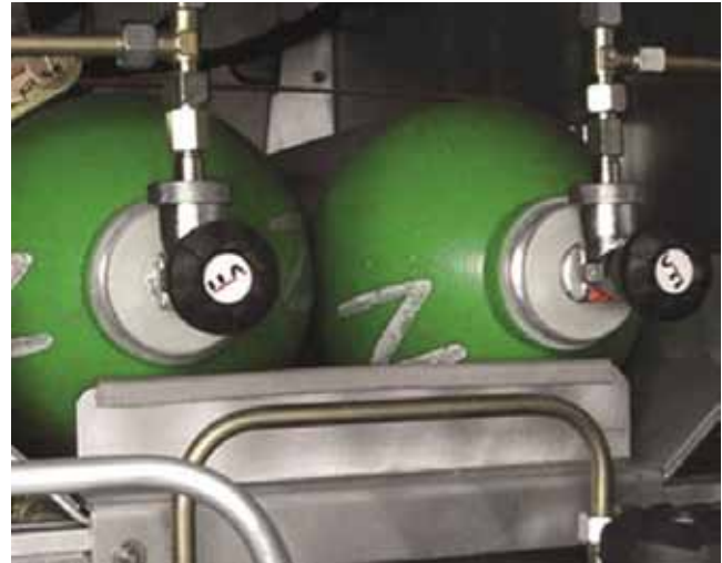
SŰRÍTETT LEVEGŐS PALACKOK – MINŐSÉGI HAB MAGAS FOKON
