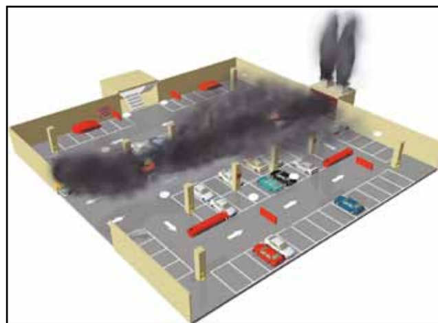
SZELLŐZTETÉS: FÜST TERJEDÉSE ÉGŐ JÁRMŰNÉL
