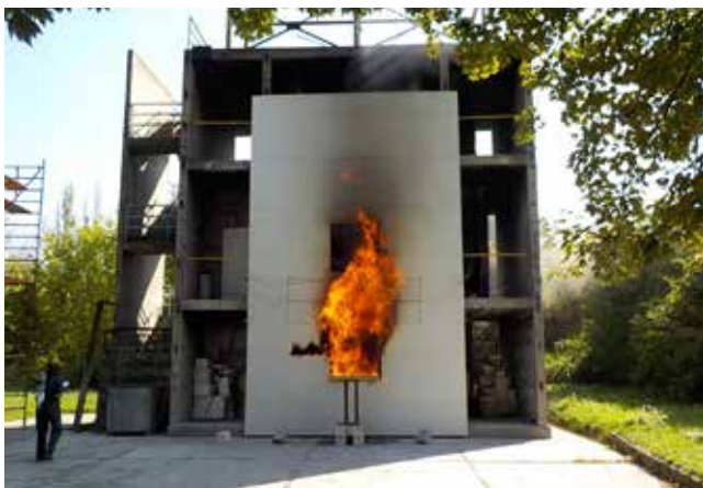
6. ÁBRA. SZERELT FALSZERKEZET VIZSGÁLATA
