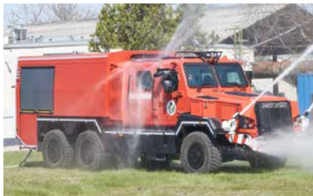
RDO-4336 KOMONDOR ALAPJÁRMŰ, VCSF-7000 TŰZOLTÓ FELEPÍTMÉNNYEL, MŰKÖDÉS KÖZBEN
