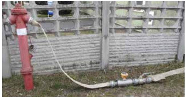
FÖLD FELETTI TŰZCSAP VÍZHOZAMMÉRÉSE
