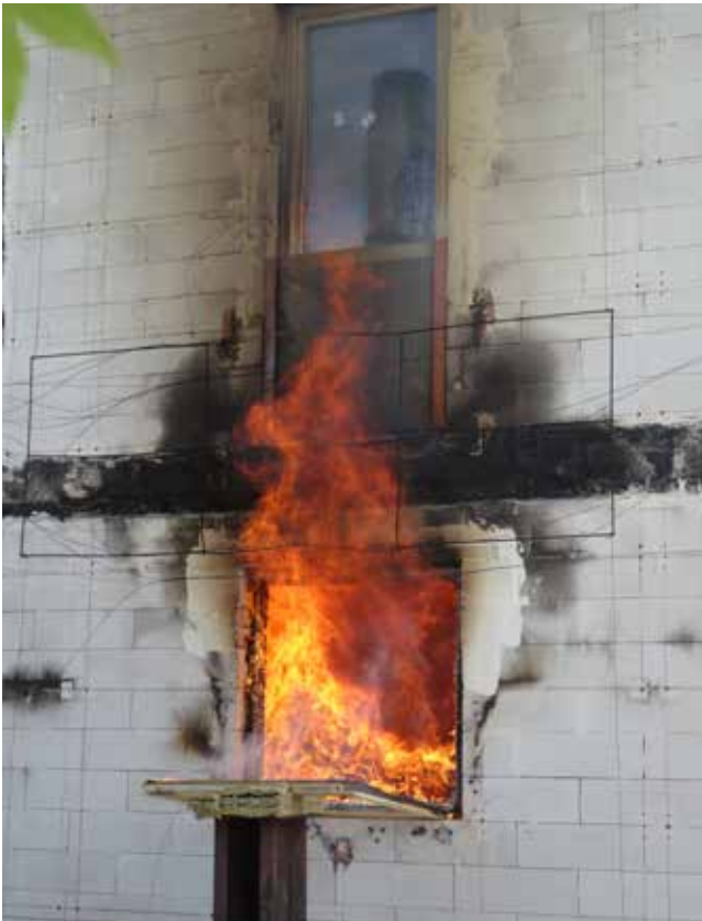
3. ÁBRA. FRANCIAERKÉLYES HOMLOKZATI KIALAKÍTÁS VIZSGÁLATA. A SZERZŐ FELVÉTELE, A MEGBÍZÓ FENSTHERM FUTURE ZRT. ENGEDÉLYÉVEL
