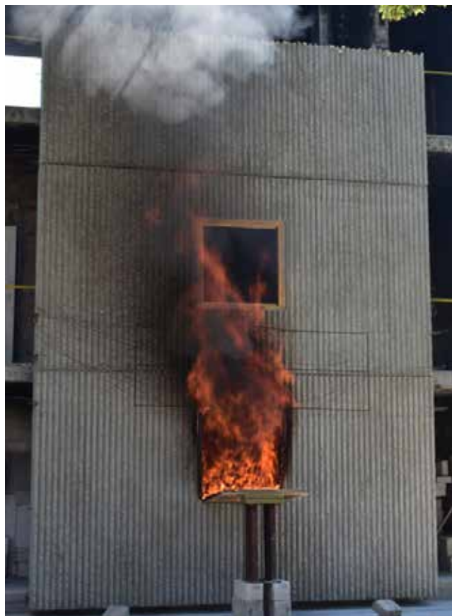
4. ÁBRA. VASBETON SZENDVICSPANELES HOMLOKZATI KIALAKÍTÁS VIZSGÁLATA. FORRÁS: ÉMI NKFT.
