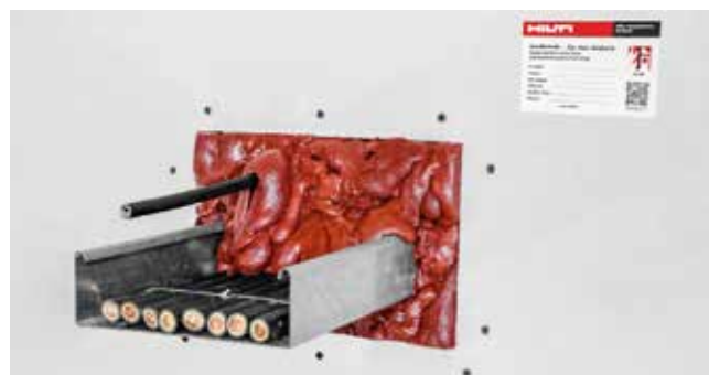
FÖDÉM-ÉS FALÁTTÖRÉSEK LEZÁRÁSAIVAL EI10-EI120 ÉRTÉK ÉRHETŐ EL
