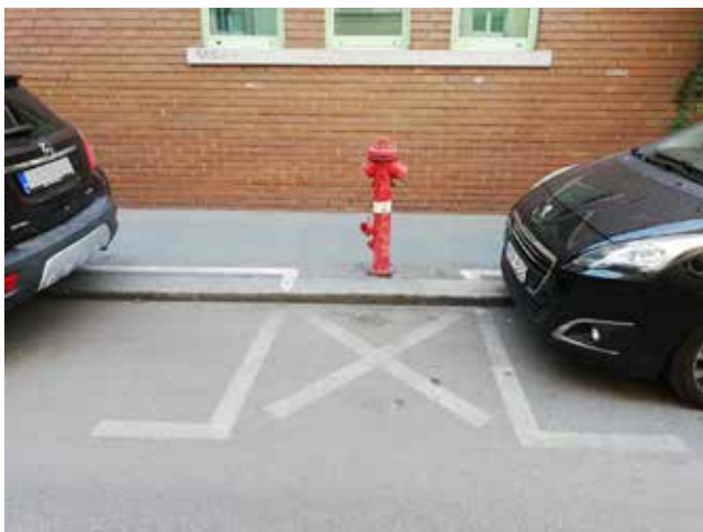
X ALAKÚ BURKOLATI JEL A TŰZCSAP ELŐTT
