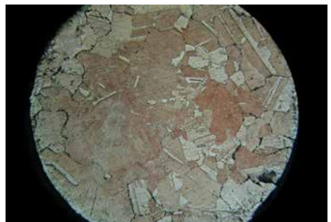
A FINOM KRISTÁLYSZERKEZETŰ VÖRÖSRÉZ KÁBELSARU METSZETI KÉPE
