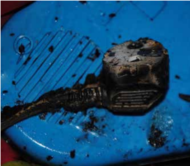
A TŰZ KELETKEZÉSI HELYÉN BEAZONOSÍTOTT FALI KONNEKTORBA CSATLAKOZTATOTT VILLÁSDUGÓ
