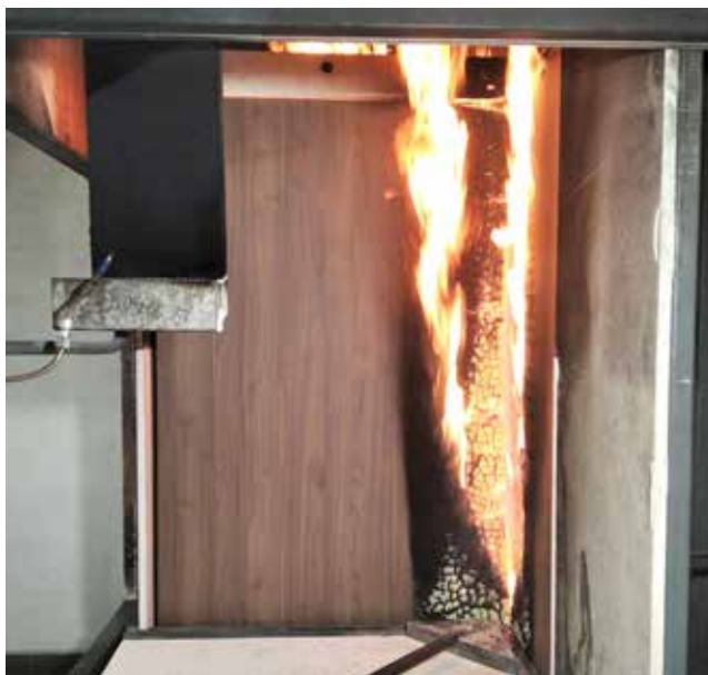
NEM SZABVÁNYOS FAFORGÁCSLAP MINŐSÍTŐ VIZSGÁLAT VÉGE (D-s1,d0)
