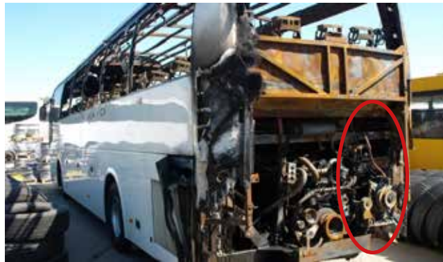
6. A KIALAKULT ÉGÉSNYOMOK AZ AUTÓBUSZ JOBB HÁTSÓ RÉSZÉBŐL (PIROSSAL JELÖLVE) INDULÓ HŐTERJEDÉST MUTATNAK
