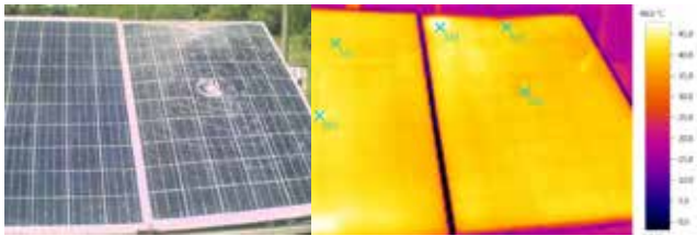
TÖREDEZETT, SÉRÜLT PANEL
