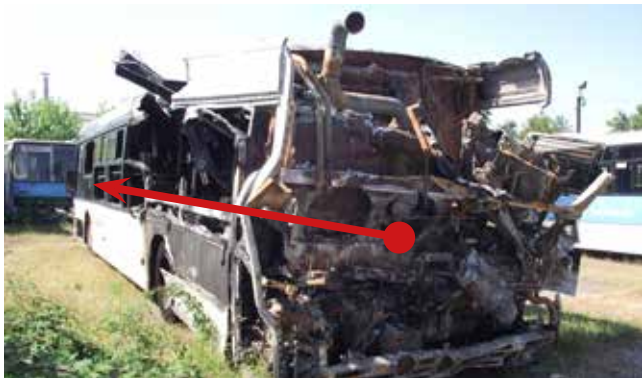
4. A KIALAKULT ÉGÉSNYOMOK EGY HÁTULRÓL ELSŐ IRÁNYOKBA MUTATÓ HŐTERJEDÉST IGAZOLNAK (A HŐTERJEDÉS IRÁNYÁT PIROS NYÍL JELZI)
