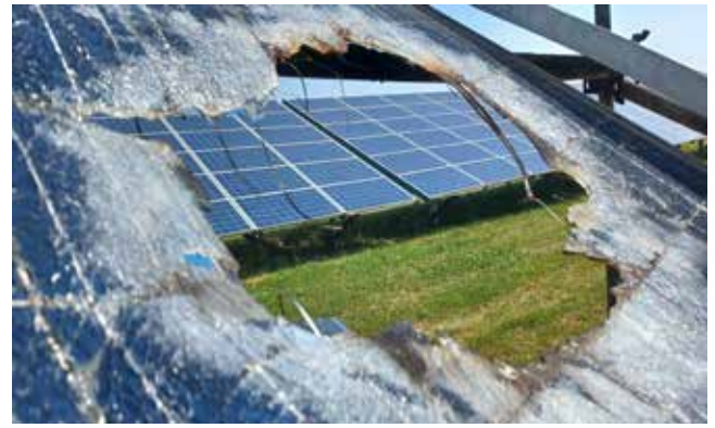
HEVÍTÉS HATÁSA A NAPELEMRE
