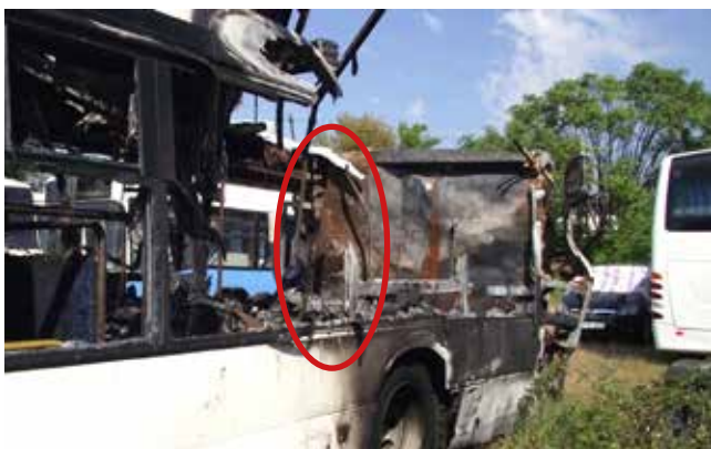
5. A KORRÓZIÓ (KELETKEZÉSI HELYE PIROSSAL JELÖLVE) AZ ÉGÉS SORÁN KIALAKULT LEGMAGASABB HŐMÉRSÉKLETŰ HELYET DETEKTÁLJA
