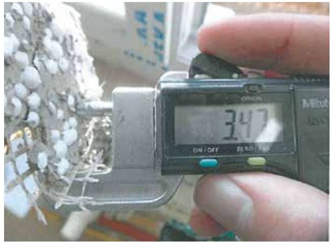
A TŰZVIZSGÁLAT SORÁN SZAKÉRTŐKÉNT KIRENDELT ÉMI ÁLTAL VÉGZETT RÉTEGVASTAGSÁG-MÉRÉS
