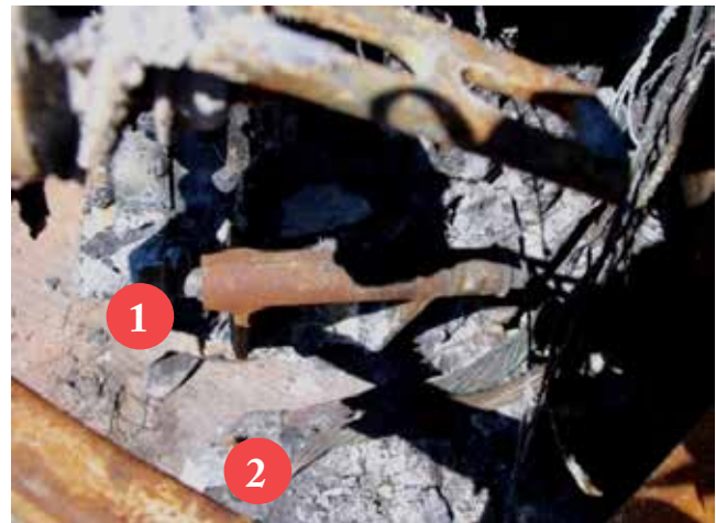
A GYULLADÁSI KÖRNYEZET (FENT) ÉS A GENERÁTOR VEZETÉKEI (LENT)
