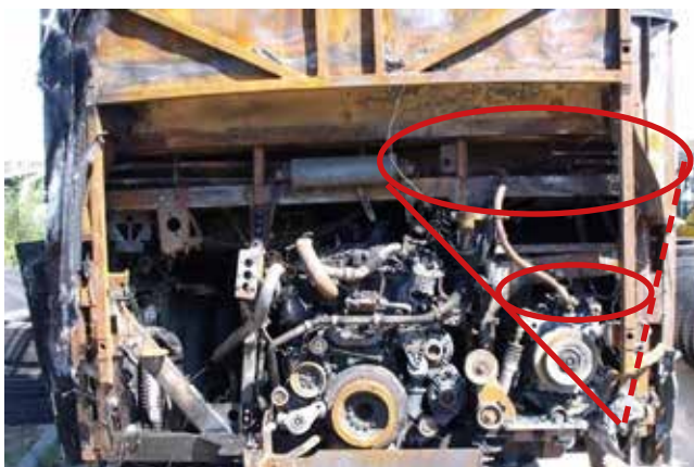
A MOTORTÉR KÁROSODÁSÁNAK ÖSSZEHASONLÍTÁSA A VALÓSÁGOS ÁLLAPOTTAL
