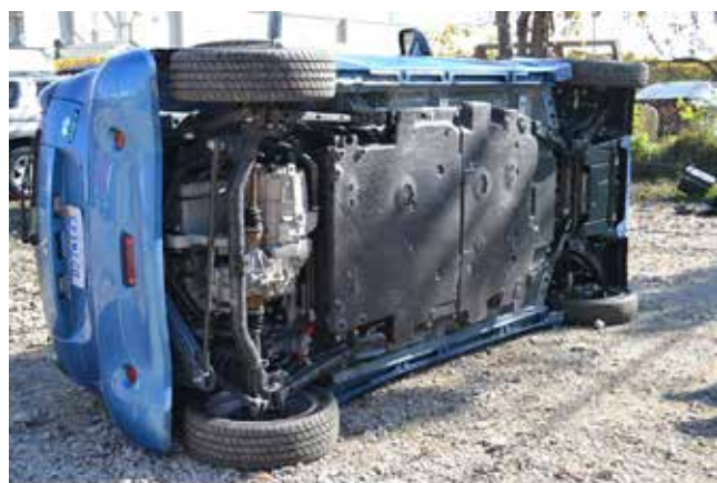
TISZTÁN ELEKTROMOS AUTÓRA JELLEMZŐ CELLÁS KIALAKÍTÁSÚ HAS, FELTŰNŐ A KIPUFOGÓ HIÁNYA IS
