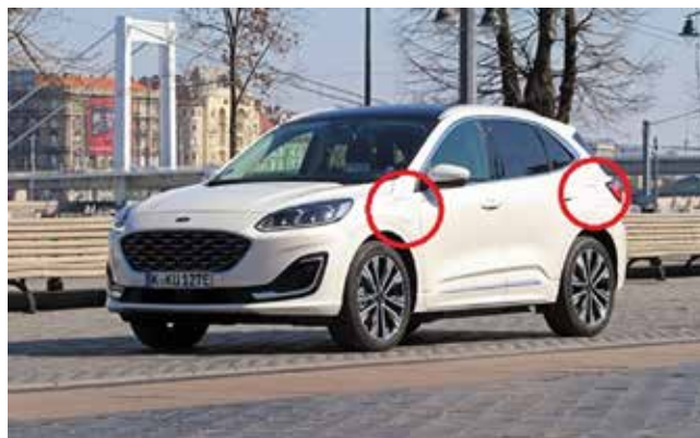
PLUG-IN HIBRID KETTŐ TÖLTŐNYÍLÁSSAL (A NYÍLÁSOK LEHETNEK EGYMÁSSAL ELLENTÉTES OLDALON IS)
