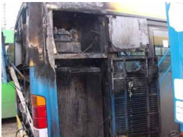
6. ÁBRA: ÉGÉSNYOMOK A HŰTŐ FELETT
