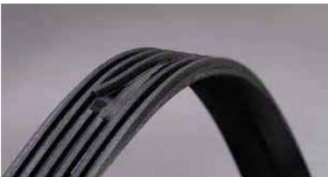
9. ÁBRA: KEZDŐDŐ MEGHIBÁSODÁS - SZÁLSZAKADÁS
