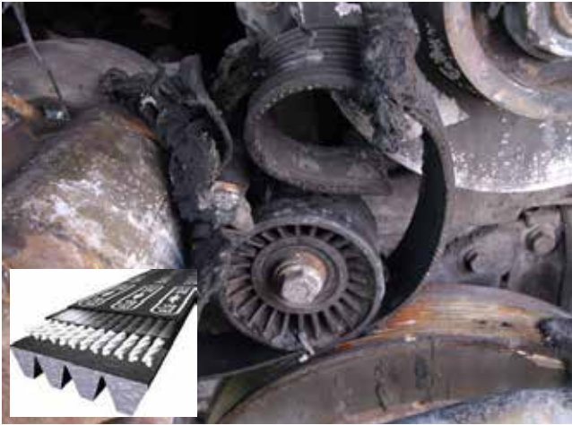
8. ÁBRA: A HOSSZBORDÁSSZÍJ ÉS SZERKEZETI FELÉPÍTÉSE
