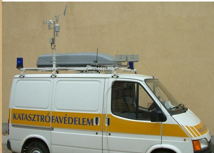
*Állványra illetve gépjárműre szerelhető megoldás, ez utóbbi menet közbeni monitorozásra is képes*
