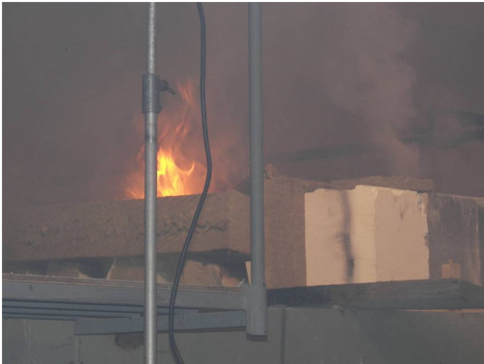
Kőzetgyapot és EPS vegyesen alkalmazva, 13 perc
