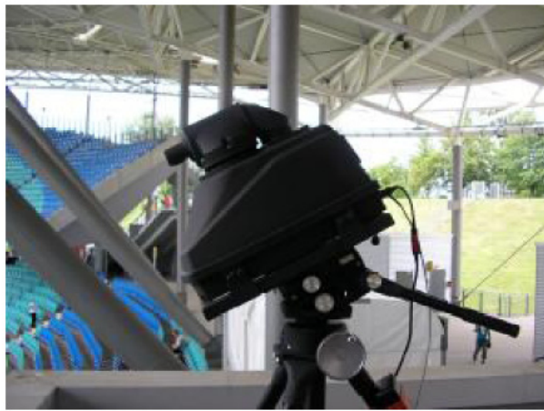
1. kép A RAPID készülék 30 fokos szögben megdőntve. Ebben a pozícióban szinte a teljes stadion lefedhető.
