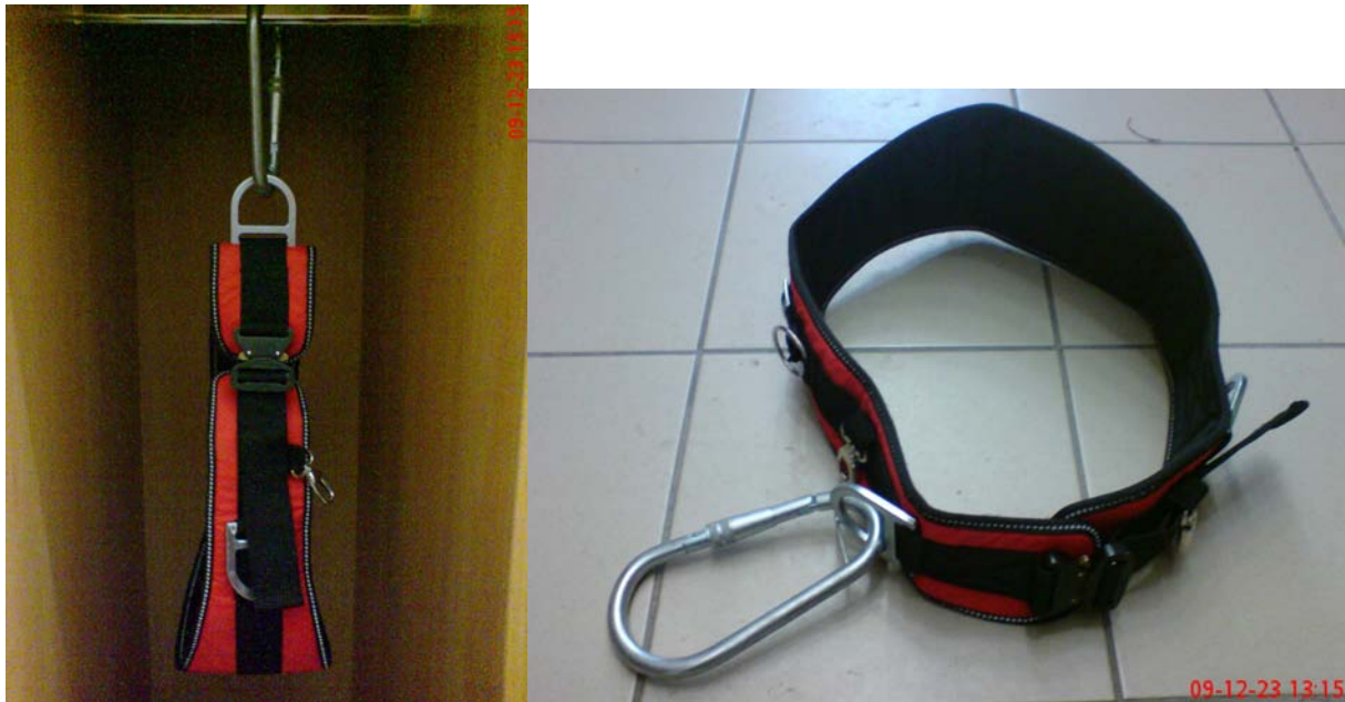
9. számú kép, tűzoltó mászóöv véletlen kicsatolás elleni menetes karabinerrel
