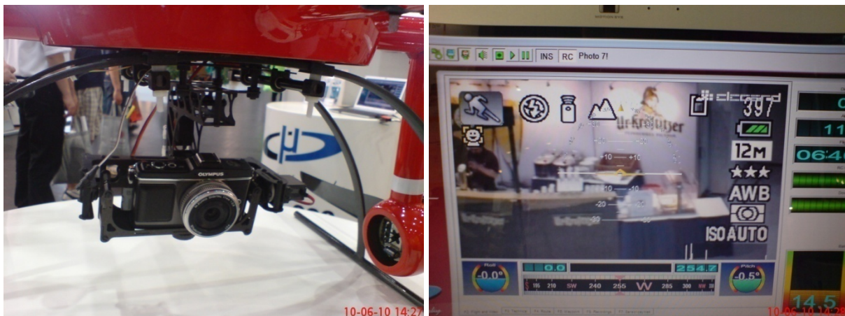
3. és 4. számú képek, Az md4-200 rögzített fényképezővel és a bázisállomás laptopján látható kép. Saját fotók, Interschutz 2010.
