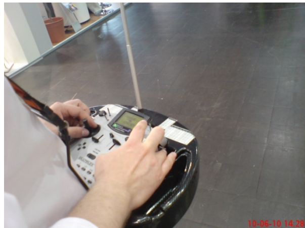
1. és 2. számú képek, A microdrones md4-200 típusú légifelderítő eszköze és távvezérlője. Saját fotók, 2010.
