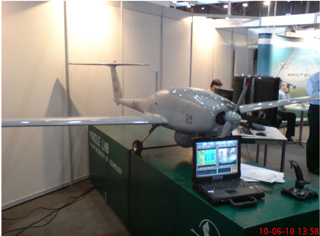
5. számú kép, Légitfelderítő pilótanélküli repülőgép beépített, forgatható kamerával. Saját fotó, Interschutz 2010.
