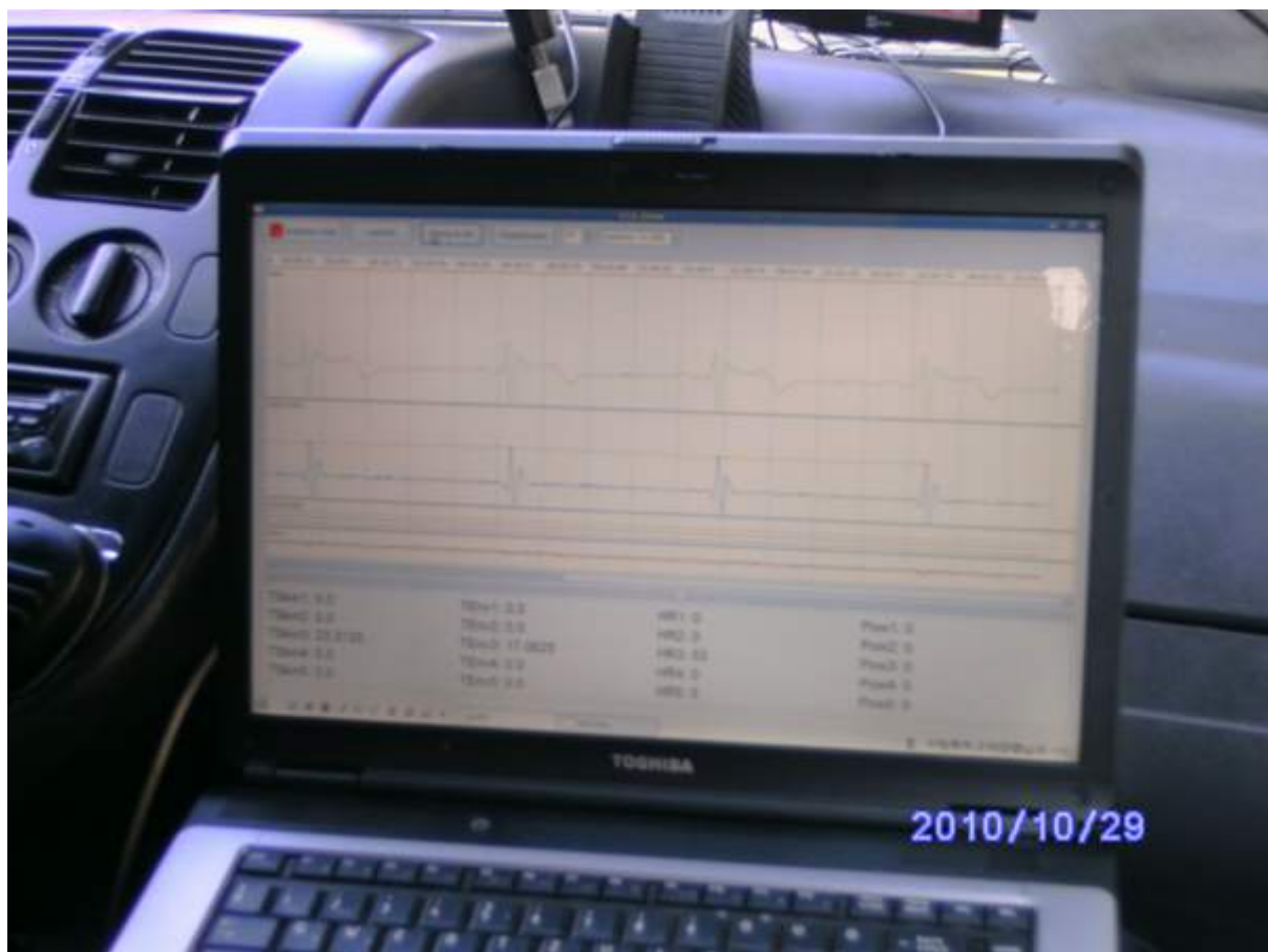
Telemetriás elemző szoftver adatai (EKG, szűrt EKG, bőrhőmérséklet, ruha alatti hőmérséklet, gyorsulásmérő) használat közben. Forrás: saját. (1. sz. és 2. sz. kép)
