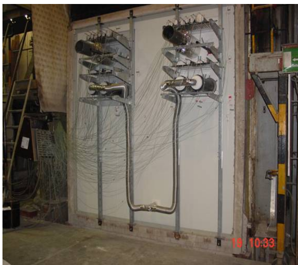
5 sz. kép. Vizsgálatra előkészített szendvicspanel szerkezet, amelybe az áttörések és védelmük beépítésre kerültek (forrás: Trimo; a kép nem Magyarországon készült)
