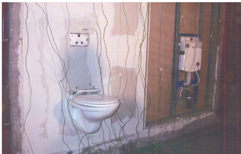
4 sz. kép. WC-t és WC tartályt tartalmazó, tűzállósági vizsgálatra előkészített gipszkarton előtétfal (forrás: ÉMI Nonprofit Kft., a kép nem Magyarországon készült)
