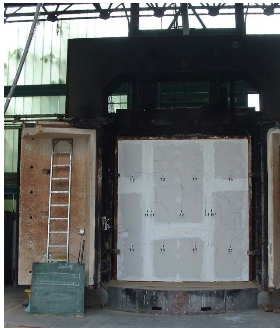
3 sz. kép. Tűzvizsgálatra előkészített gipszkarton fal. Jól látható, hogy a szerkezet semmilyen, a felületfolytonosságot megszakító kiegészítő szerkezetet - pl. WC tartály nyomólappal, elektromos dugalj stb. - nem tartalmaz (fotó: ÉMI Nonprofit Kft)
