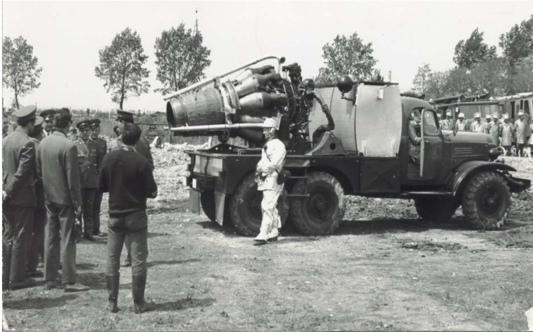
2. sz. MiG-15 - szubszónikus sugárhajtású repülőgép - hajtóművével épült turbóreaktív oltógép
