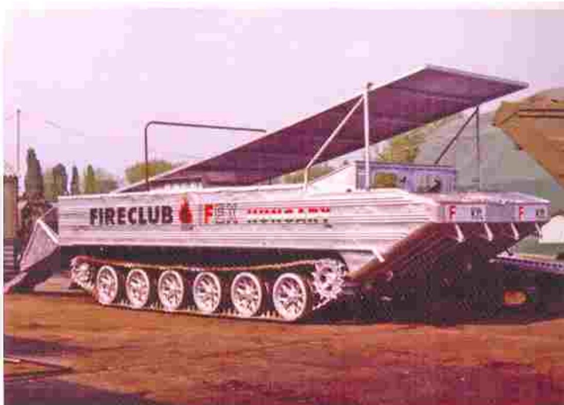
8.sz. kép PTSZ-re szerelt impulzusoltó
