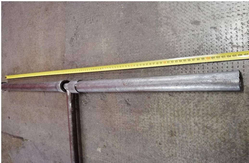
21. képsorozat - Az 1 és 2 erőkarral megnövelt föld alatti tűzcsapkulcs mérése forrás: saját fotók
