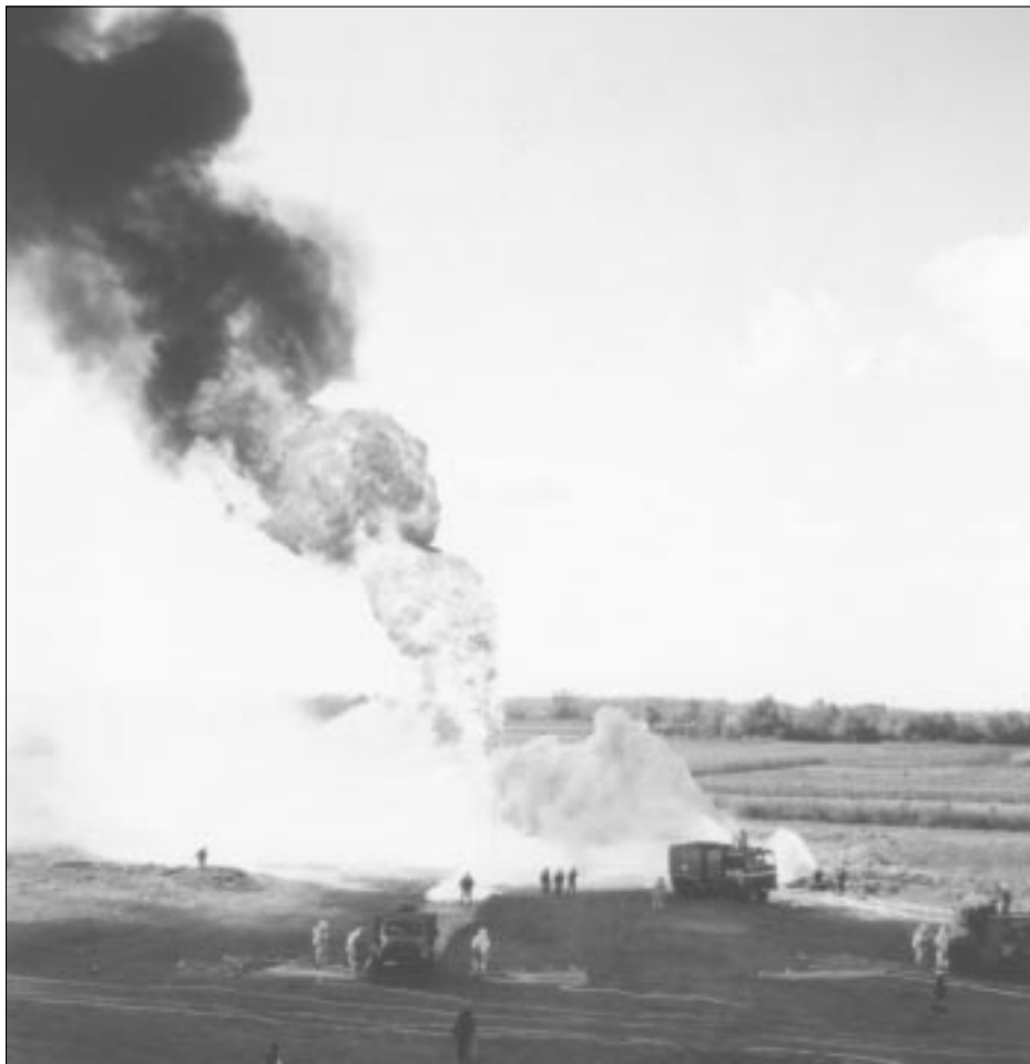
Porral oltási kísérlet az Üllési kútkitörési gyakorlaton 1998-ban
