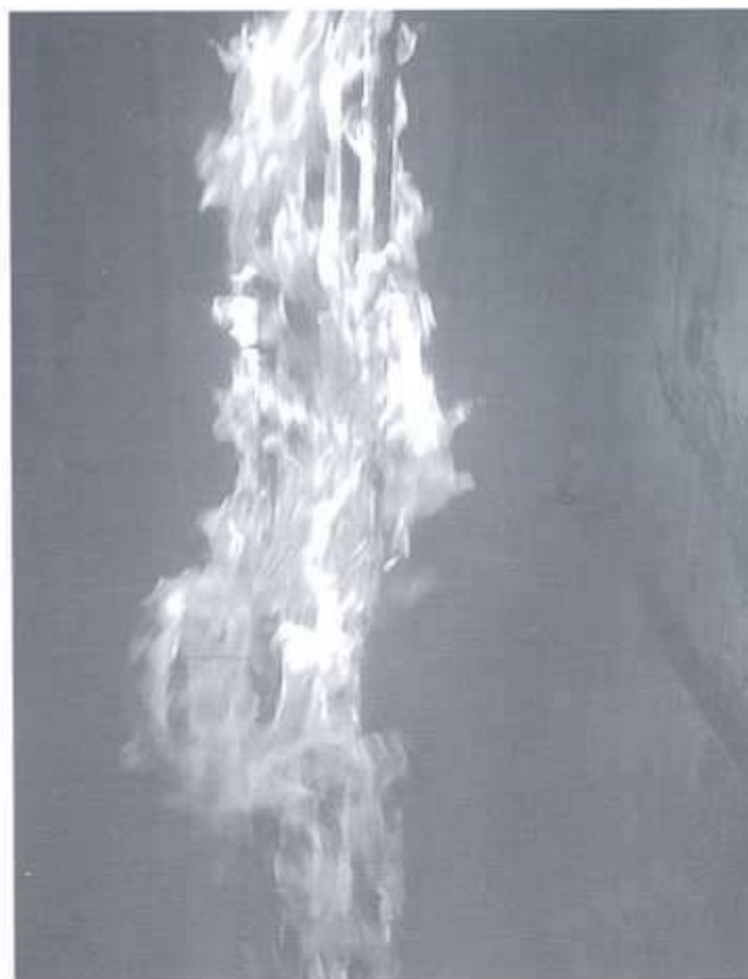
Kábelek függőleges lángterjedés (IEC 60332-3) vizsgálatának 30. perce
