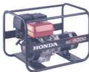
EC 4000 áramfejlesztő 1x 4000 W, 2,9 liter/óra fogyasztás max. terhelésnél 4 kVA, kondenzátoros szabályzás 4 ütemű
