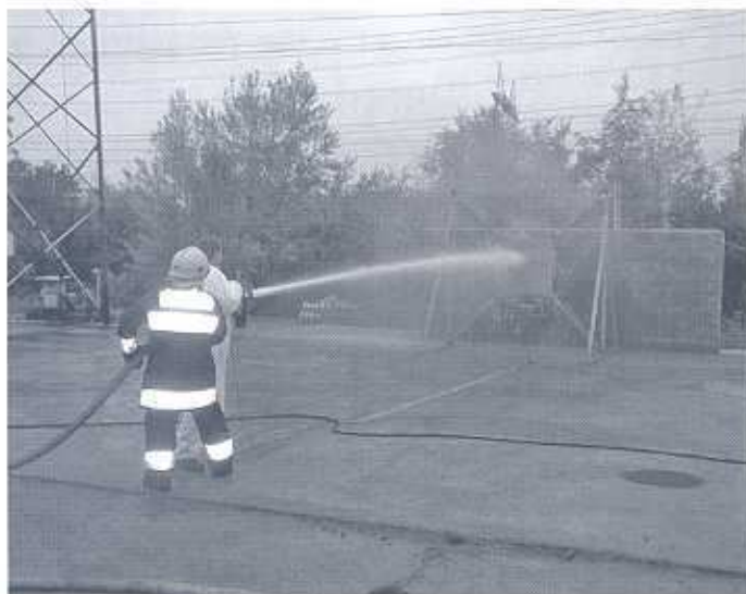
Vízzel oltó sugárcső MSZ EN 3 szabvány szerinti szigetelés vizsgálata U=15 kV feszültségen
