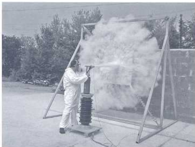
CO 2 kézi tűzoltó készülék MSZ EN 3 szabvány szerinti szigetelés vizsgálata U=70 kV feszültségen
