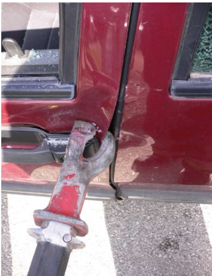
4. ábra. A rés kialakítása Force-baltával
