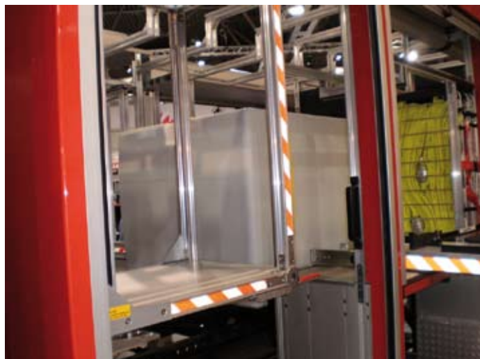
Ziegler csavarozott profilokból készített felépítmény
