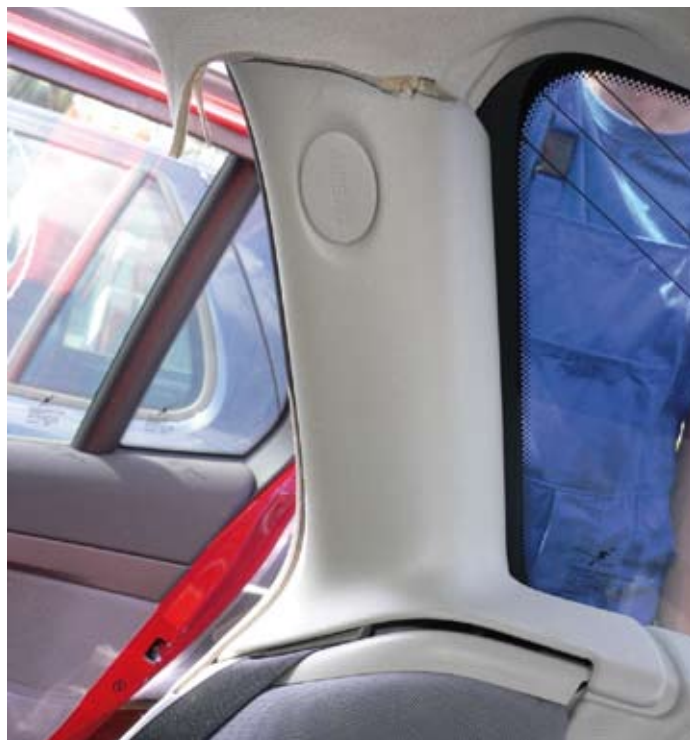
1. ábra. A burkolaton jól látható a légzsákra figyelmeztető „AIRBAG” jelzés
