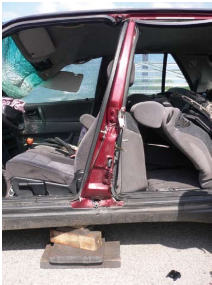
20. ábra. Fontos mozzanat az aláépítés
