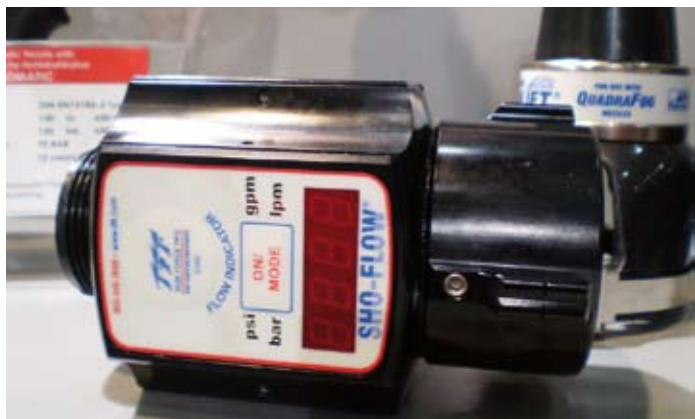
Digitális kijelzővel ellátott víznyomás és vízátfolyás mérő berendezés
