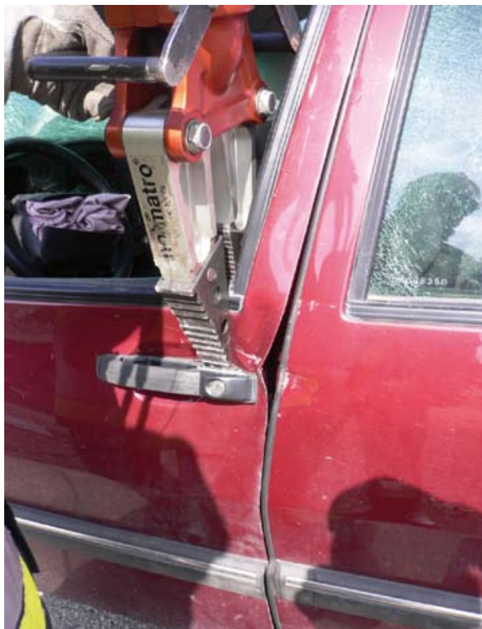
5. ábra. A rés kialakítása hidraulikus feszítővel
