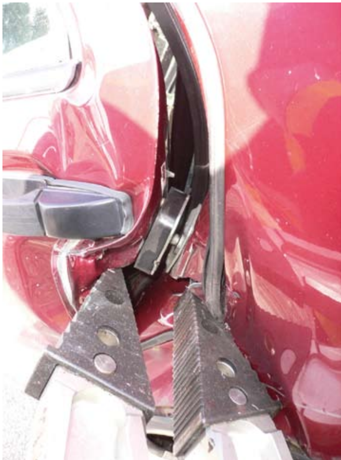
7. ábra. Lehetőleg a zárszerkezet közelében dolgozzunk
