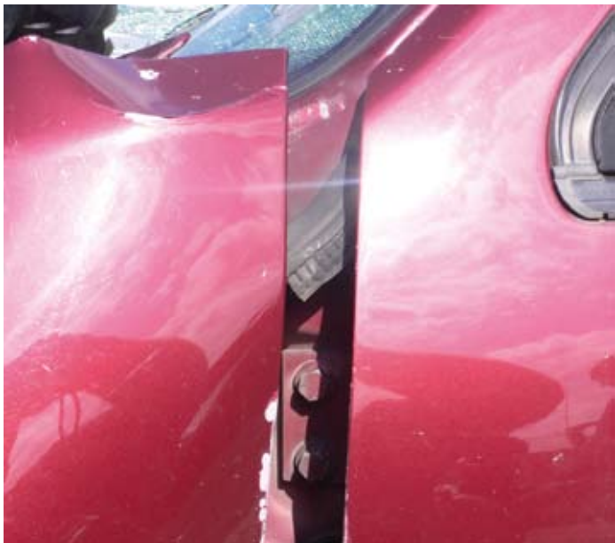
11. ábra. Az elem megroppantása után szabaddá vált a zsanér
