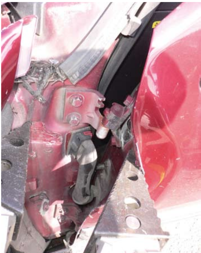
12. ábra. Dolgozzunk közel a zsanérhoz és feszítsük, ne vágjuk!
