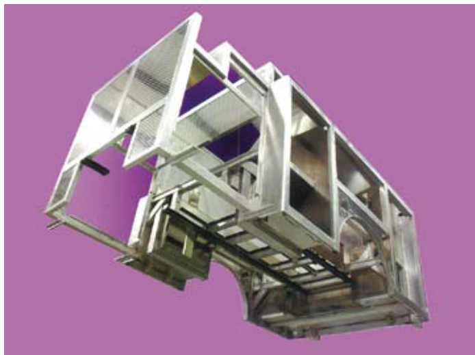
Ferrara hegesztett felépítmény
