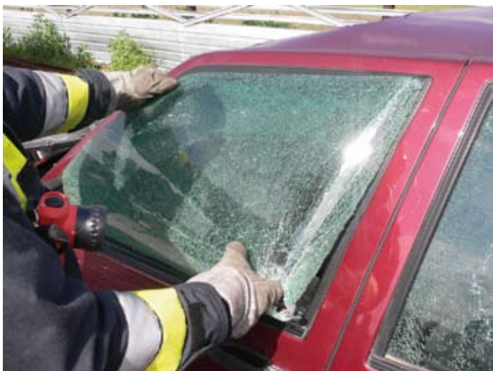
3. ábra. A berepesztett üveg könnyen kiemelhető a keretéből
