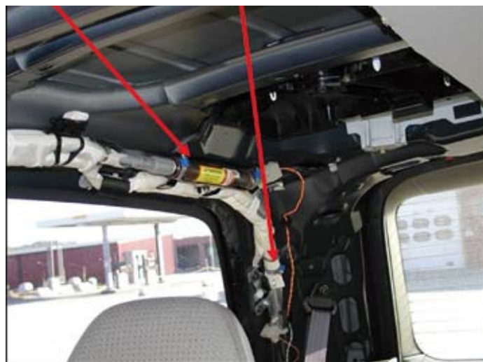
2. ábra. A burkolat alatt megbújó légzsákrendszerek
