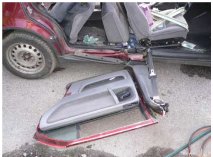
19. ábra. Jól láthatóan másként szakadt az oszlop alja, mint a vízszintes bevágásnál
