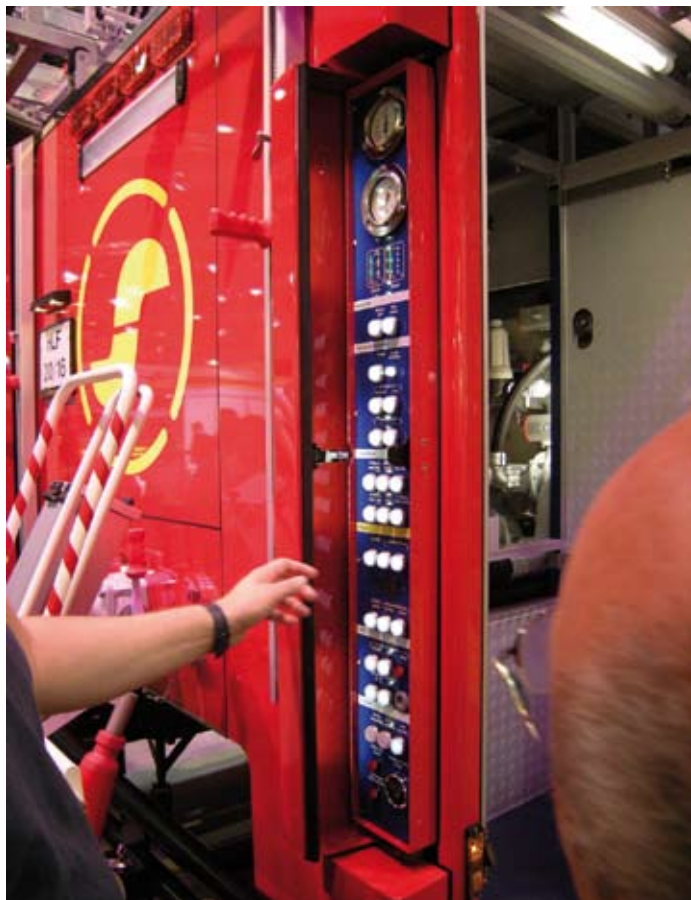
Hátfalba integrált vezérlő rendszer
