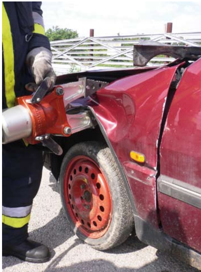
9. ábra. A sárvédő megroppantása
