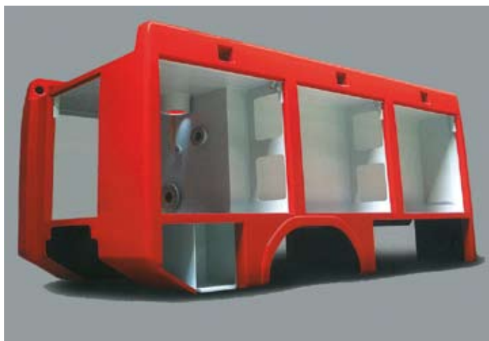
Üvegszálás poliésztergyanta felépítmény
