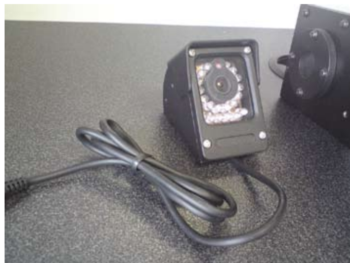
Éjjellátó kivitelű kamera
