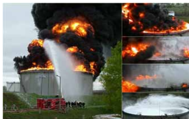
2. ÁBRA: NAGYFELÜLETŰ TARTÁLYTŰZOLTÁSI KÍSÉRLET
