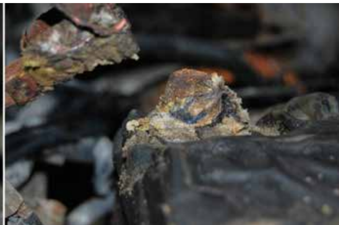
SÉRÜLT AKKUMULÁTORSARU (BALRA) ÉS SÉRÜLT AKKUMULÁTORPÓLUS (JOBBRA)
