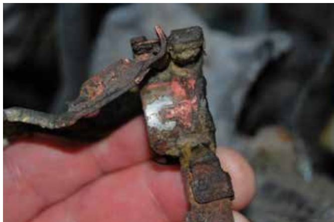
SÉRÜLT AKKUMULÁTORSARU (BALRA) ÉS SÉRÜLT AKKUMULÁTORPÓLUS (JOBBRA)
