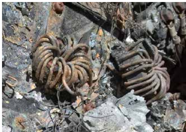
ELEKTROMOS GÉPKOCSIBA BEÉPÍTETT TÖLTŐEGYSÉG MARADVÁNYAI EGY TŰZ UTÁN
