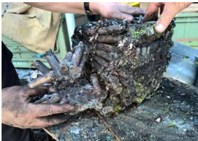
A FELROBBANT LÍTIUMCELLA-CSOMAGBÓL ÁLLÓ AKKUMULÁTOREGYSÉG
