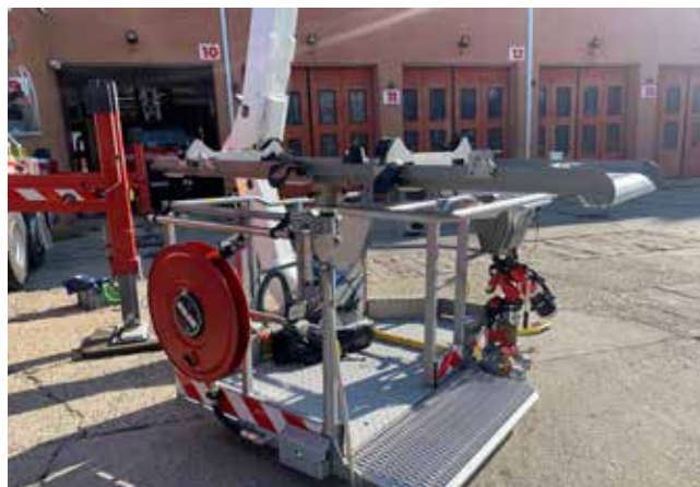
MUNKAKOSÁR TŰZOLTÓ TECHNIKÁVAL
