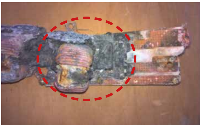
A TRANSZFORMÁTOREGYSÉG TÚLMELEGEDETT
