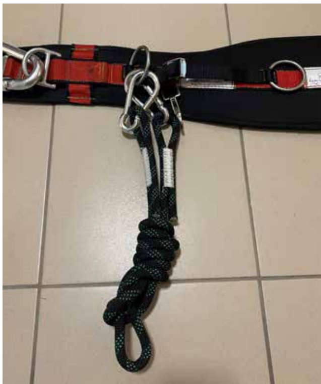
MÓDOSÍTOTT TÖMLŐTARTÓ KÖTÉL MÁSZÓÖVRE RÖGZÍTVE
