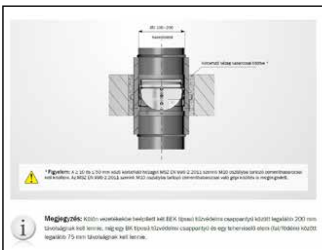
7. ÁBRA - PÉLDA EGY GYÁRTÓ ALKALMAZÁSTECHNIKAI UTASÍTÁSÁBÓL A CSAPPANTYÚ SZAKSZERŰ, A MINŐSÍTÉSNEK MEGFELELŐ BEÉPÍTÉSÉHEZ
