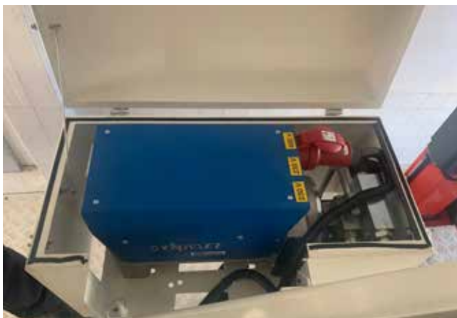
KOMPAKT ÁRAMFEJLESZTŐ HIDROMOTORRAL
