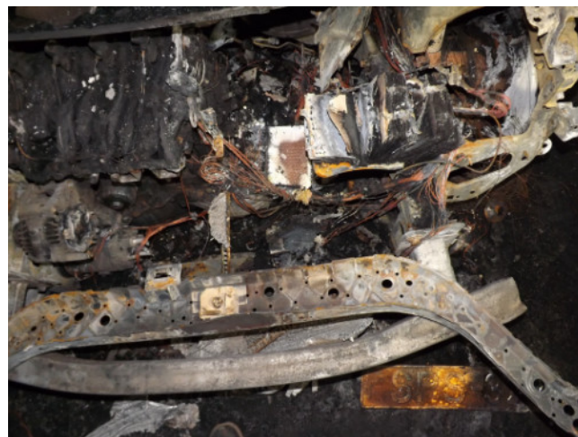
A ZÁRHÍDON AZ AKKU FELETT INTENZÍV HŐTERHELÉS (A KÉP BAL FELSŐ SARKÁBAN AZ AKKU MARADVÁNYAI)
