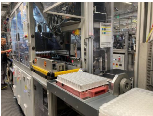
A CELLÁK ADAGOLÁSÁT ROBOTOK VÉGEZIK
