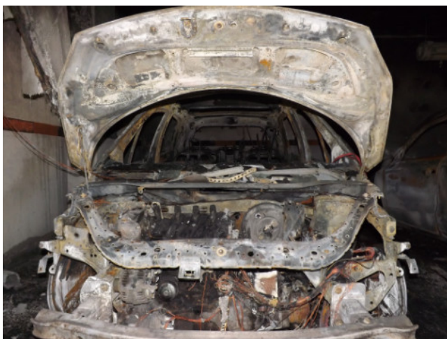
ÉGÉSNYOMOK AZ AKKU FELETT ÉS A JÁRMŰVÖN
