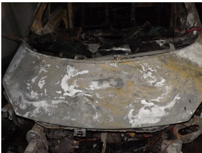
A MAGASABB HŐTERHELÉS, AZ ERŐS KIÉGÉS JELEI
