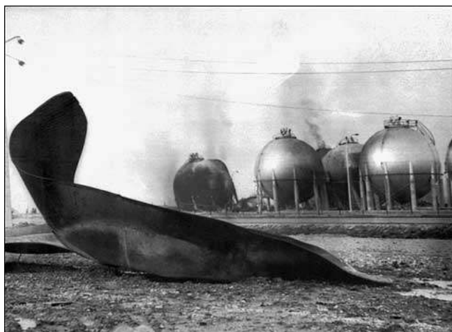
6. kép. A felrobbant tartály egy darabja (Forrás: www.onoci.net )
